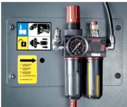
Servicebox: Manuelle Entriegelung und Druckluftanschluss an der Wartungseinheit
