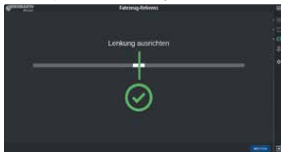
Controllo della posizione del volante prima della calibrazione
