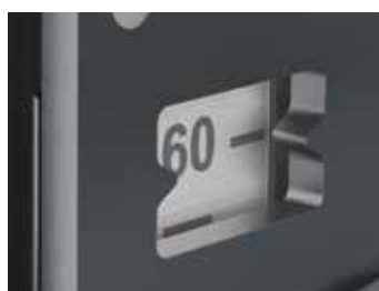
Indicatore manuale dell'altezza sulla scala graduata in alluminio (di serie). La scala graduata può essere regolata in altezza per compensare la differenza di livello con l'area di stazionamento del veicolo.
