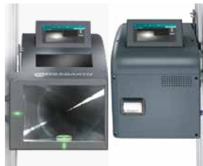
Quadro di controllo orientabile montato sul gruppo ottico. Una singola pressione consente all'operatore di modificare la direzione di visualizzazione (anteriore, per l'ispezione, posteriore, per la regolazione). Il sistema commuta immediatamente e in modo automatico l'orientamento della pagina sullo schermo.
