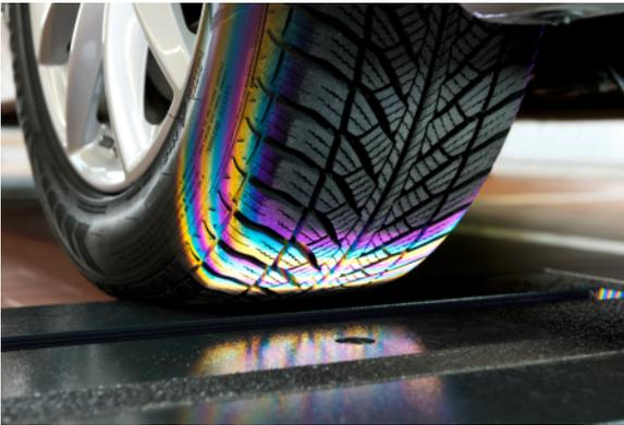
Mit der Profiltiefenmessung kann das Reifen und Servicegeschäft in der Werkstatt besser gesteuert werden, zudem werden abgefahrene Reifen frühzeitig erkannt. Ungleichmäßig abgefahrene Reifenprofile sind für die Werkstatt ein Hinweis, die Fahrwerkeinstellung zu überprüfen, und dem Kunden ggf. eine Fahrwerkvermessung vorzuschlagen. Beissbarth Easy Tread liefert einen Beitrag zur Umsatz- und Margensteigerung im Betrieb.
