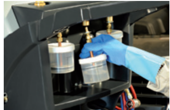
Hermetisch abgeschlossene Ölbehälter zur feuchtigkeitsfreien und sauberen Lagerung von Kältemittelölen und UV-Lecksuchadditiv
