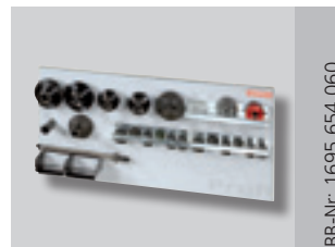
Spannkit für Einarmschwingen mit Welle (Ø 19 mm)
