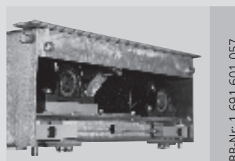
4-Punkt Waage als Nachrüstset, für automatische Berechnung der Achs- und Gesamtabbremmung
