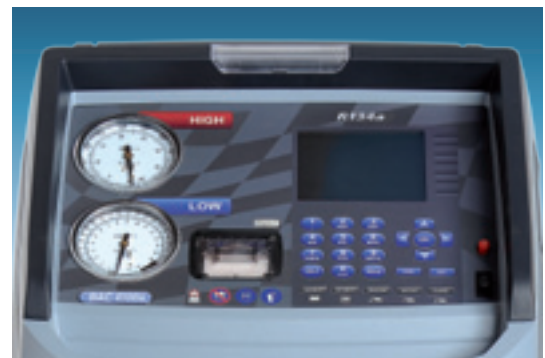
Bedieneinheit mit 5,7-Zoll Farbdisplay und integriertem Drucker
